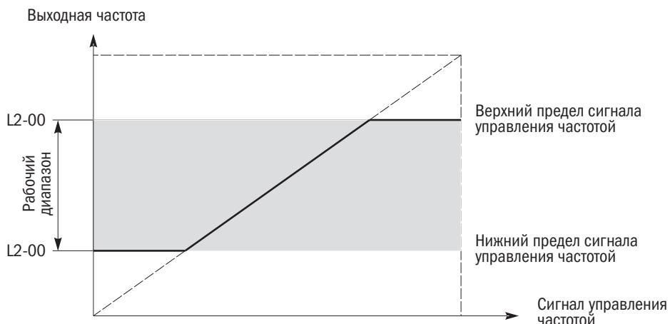
Рисунок 70. Верхний и нижний пределы сигнала управления частотой
