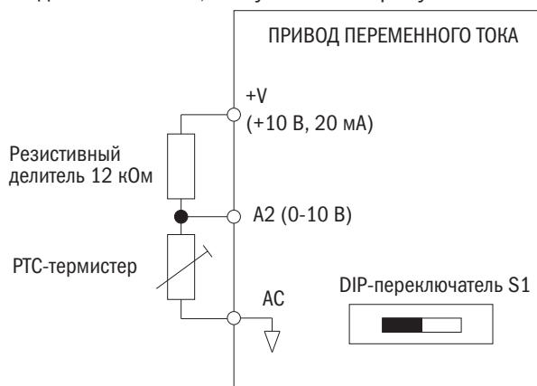
Рисунок 116. Подключение РТС-ввода
