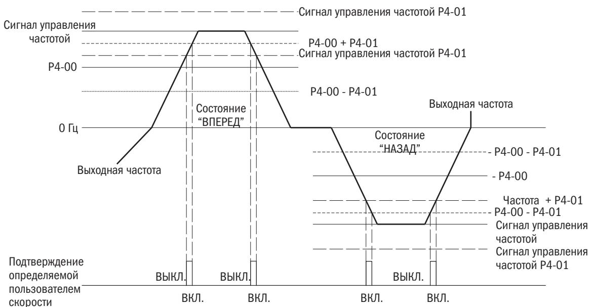
Рисунок 96. Операция подтверждения определяемой пользователем частоты (скорости)
