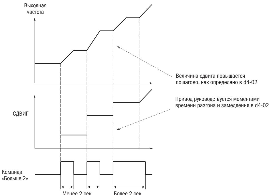
Рисунок 72. Сдвиги по «Больше 2» / «Меньше 2» при L4-01 > 0,0 Гц
