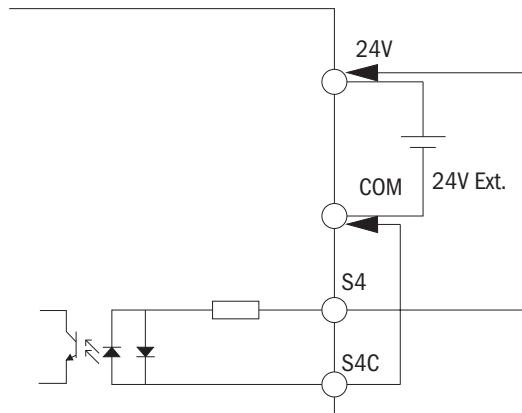
Рисунок 31. Подключение клеммы S4 (PNP)
