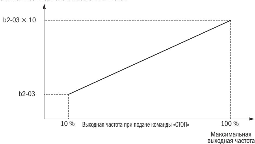
Рисунок 50. Время торможения током DC зависит от выходной частоты
