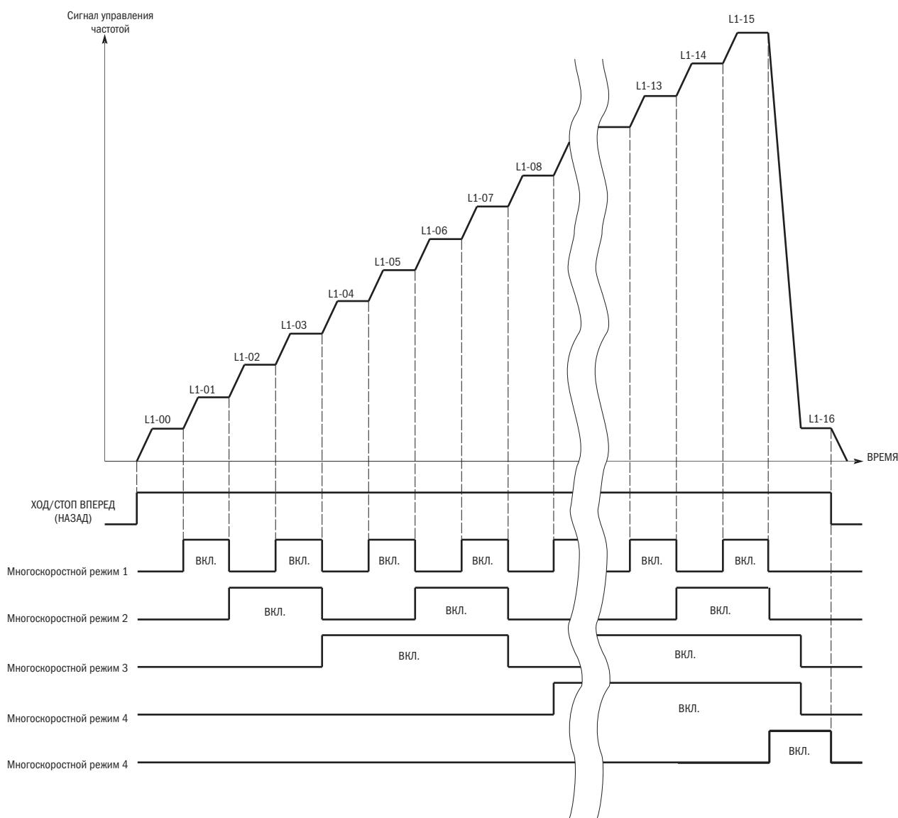
Рисунок 69. Функция сигнала управления частотой толчкового хода
