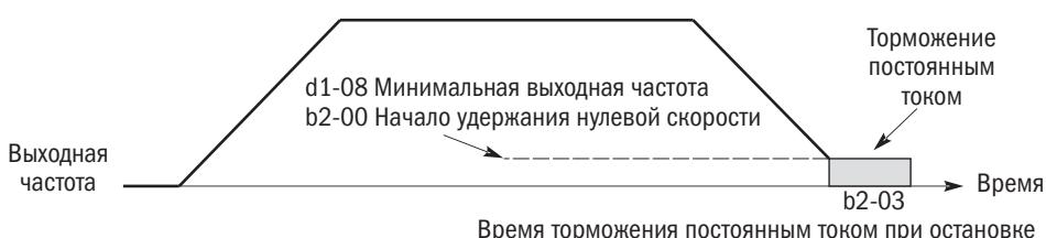
Рисунок 53. Время торможения постоянным током при остановке
