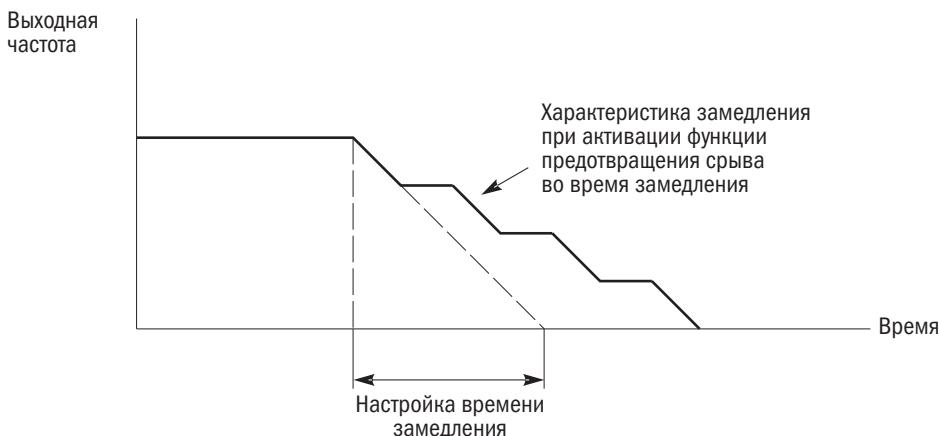
Рисунок 124. Предотвращение срыва в процессе операции замедления
