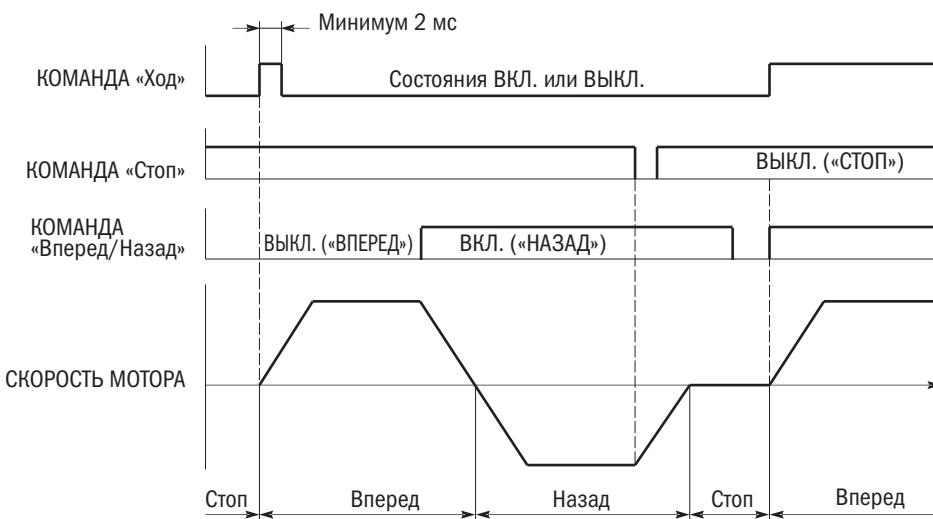
Рисунок 88. Операция последовательного подключения 3 проводов
