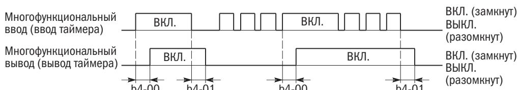
Рисунок 55. Работа функции таймера
