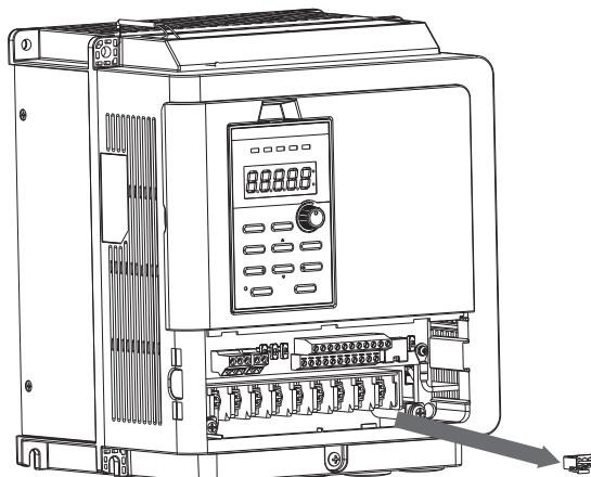
Рисунок 25. Снятие перемычки
