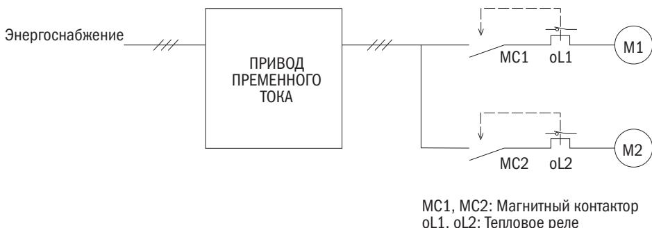
Рисунок 114. Цепь системы защиты для нескольких моторов
