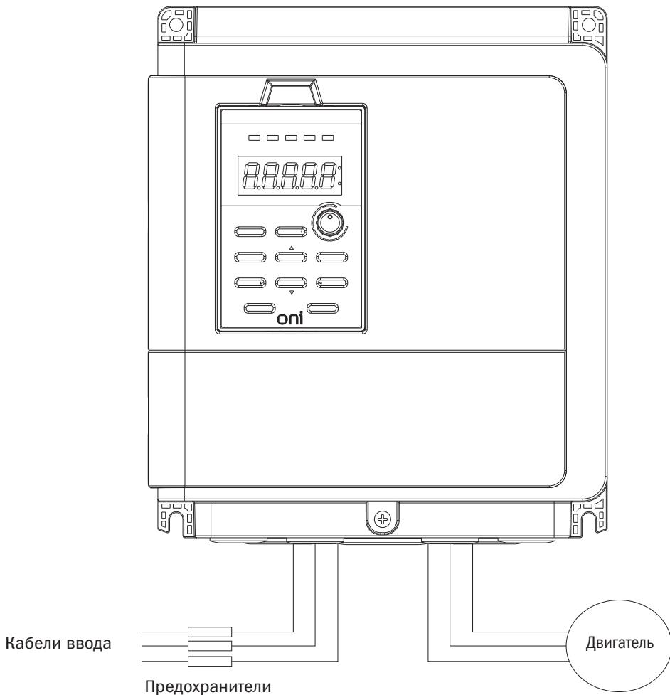
Рисунок 20. Установка предохранителя
