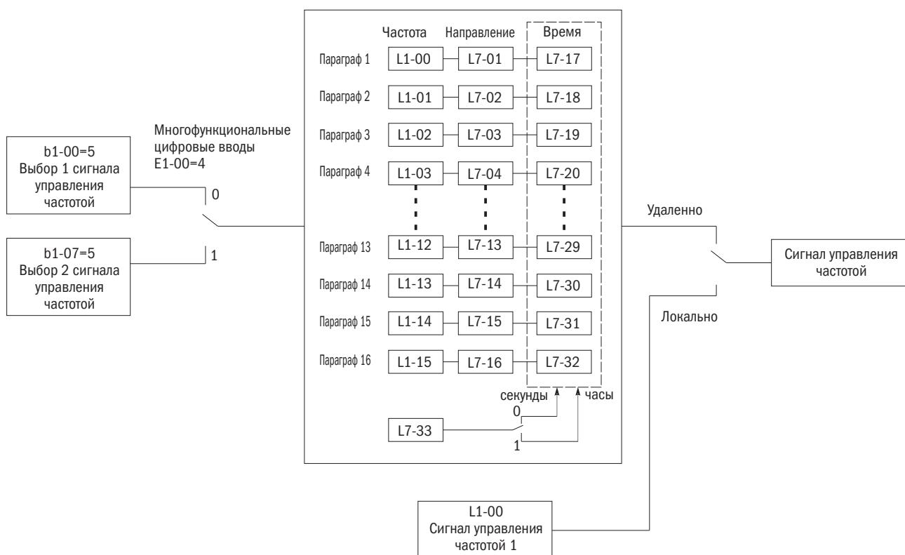
Рисунок 76. Диаграмма работы преобразователя в автоматическом режиме.
