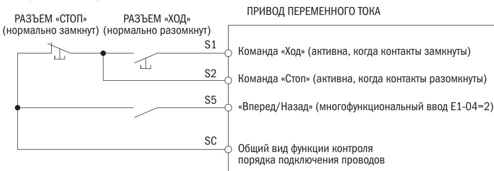
Рисунок 87. Диаграмма последовательности подключения проводов
