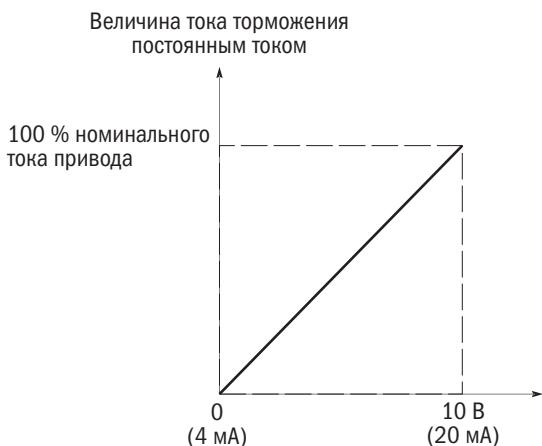
Рисунок 106. Ток торможения DC-током с использованием аналогового ввода
