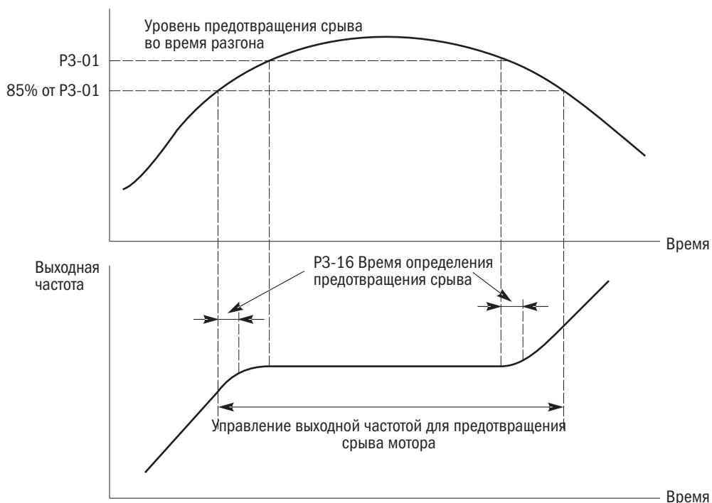
Рисунок 121. Предотвращение срыва при разгоне для моторов с внутренними магнитами
