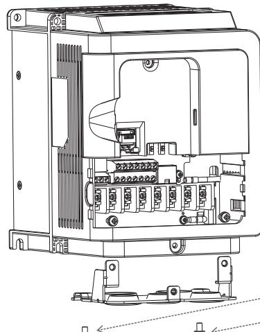
Шаг 4: отвинтите винт кронштейна и снимите его
