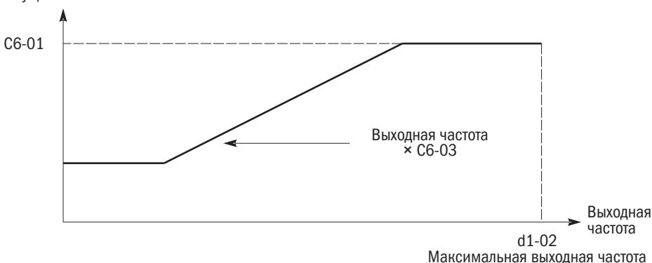
Рисунок 67. Изменения несущей частоты на основе параметров выходной частоты
