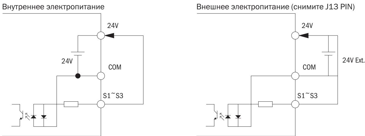
Рисунок 29. Подключение клемм S1-S3 (PNP)
