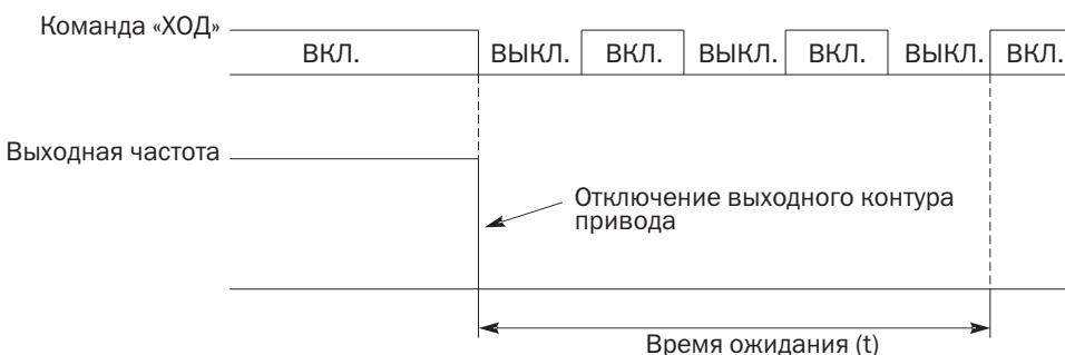
Рисунок 51. Выбег до остановки с использованием таймера
