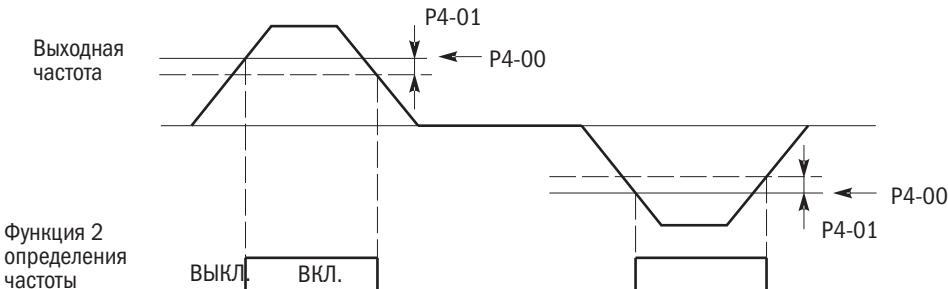
Рисунок 98. Операция определения 2 выходной частоты (FOUT)
