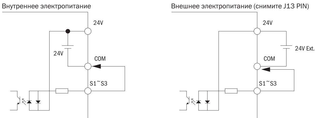
Рисунок 28. Подключение клемм S1-S3 (NPN)
