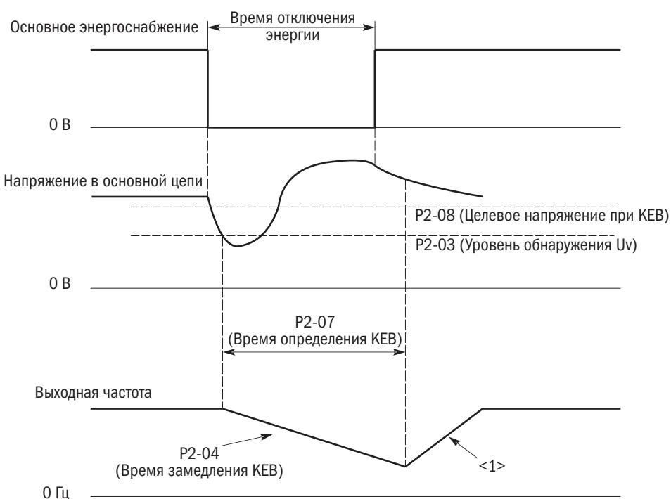
Рисунок 118. Метод 2 управления KEB (P2-00 = 3 и P2-09 = 1 без использования контактов многофункционального ввода для KEB)
