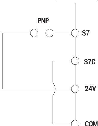
Рисунок 33. Подключение клеммы S7
