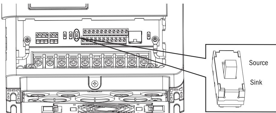
Рисунок 35. Двухпозиционный переключатель ПРИЁМНИК/ИСТОЧНИК < 5,5 кВт
