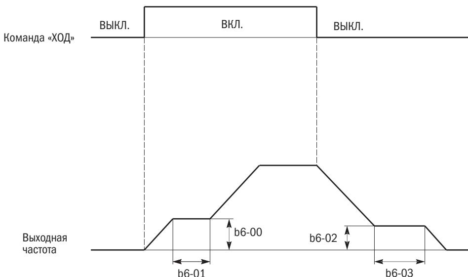
Рисунок 61. Функция задержки при пуске и остановке
