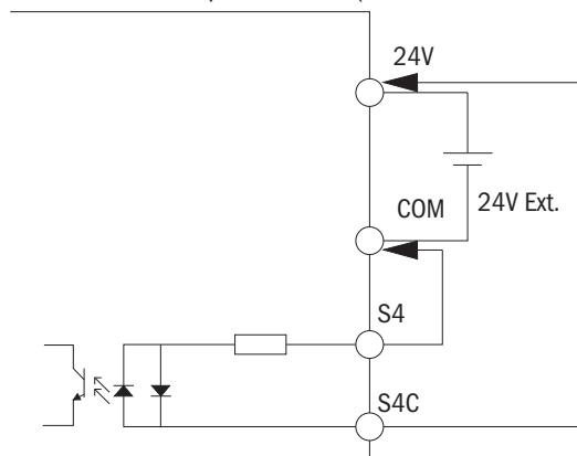
Рисунок 30. Подключение клеммы S4 (NPN)
