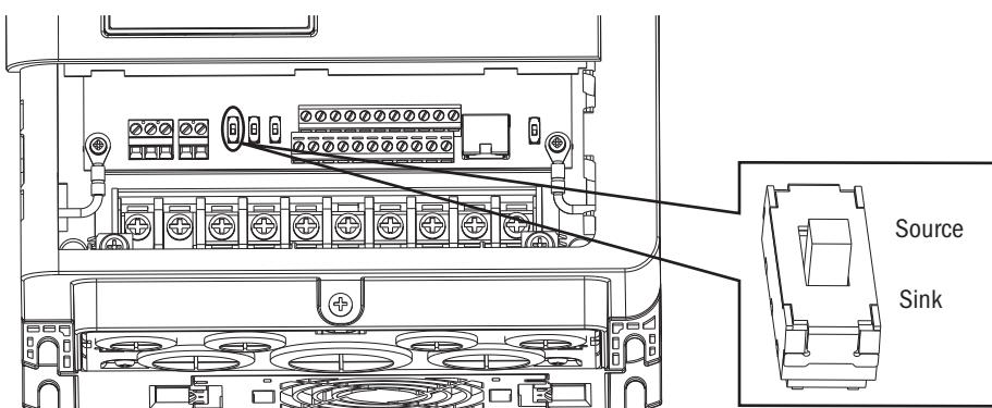
Рисунок 36. Двухпозиционный переключатель ПРИЁМНИК/ИСТОЧНИК > 7,5 кВт
