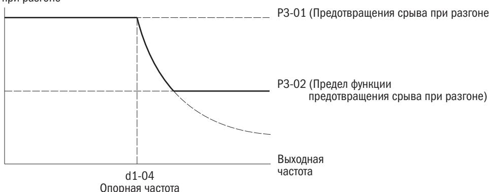
Рисунок 123. Уровень предотвращения срыва при разгоне
