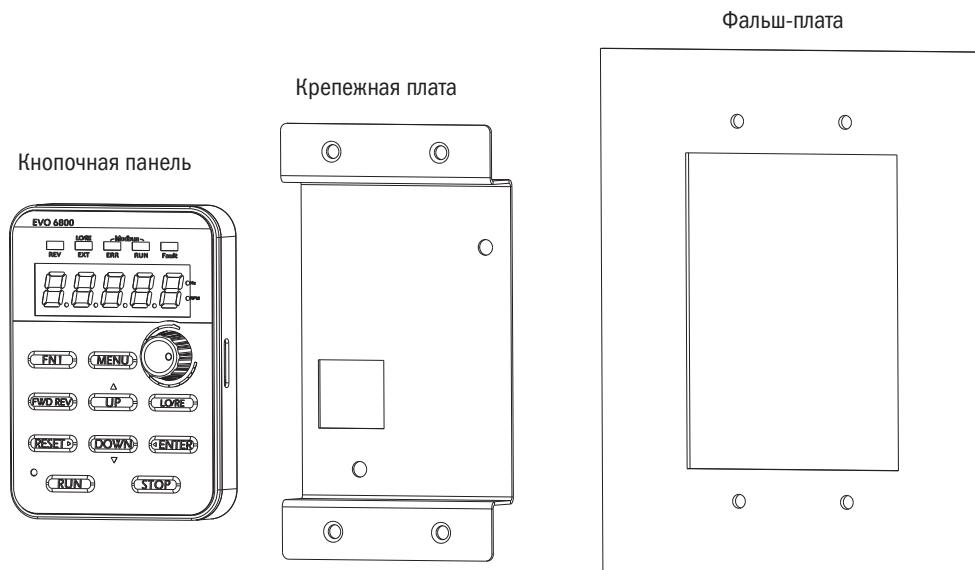
Шаг 2: Крепеж кнопочной панели на фальш-плате 2 винтами (M4×0,7×6mm)
