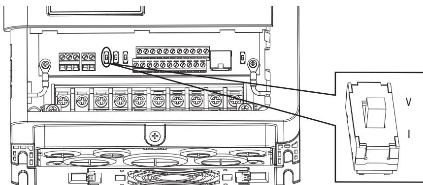
Рисунок 37. Двухпозиционный переключатель A2 < 5,5 кВт
