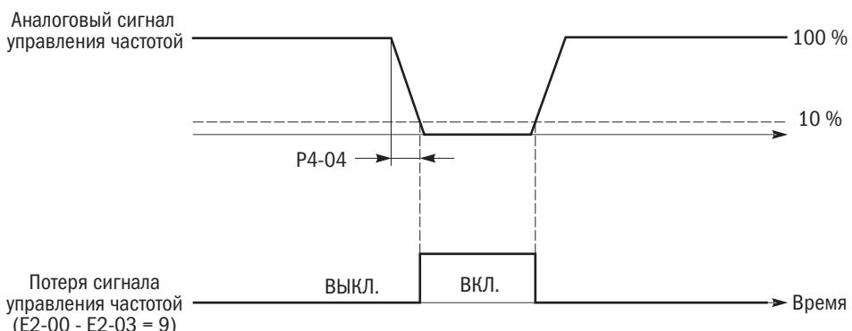
Рисунок 126. Операция выявления потери сигнала управления частотой
