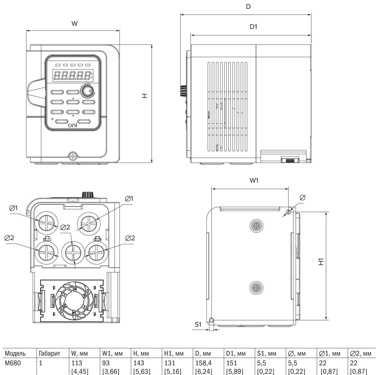
Рисунок 9. Размеры габарита 1
