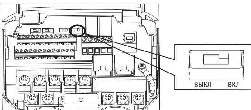
Рисунок 40. Двухпозиционный переключатель терминального резистора
