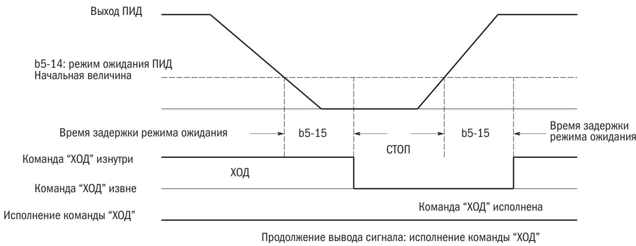
Рисунок 60. Функционирование режима ожидания ПИД
