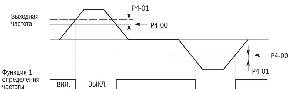
Рисунок 97. Операция определения 1 выходной частоты (FOUT)
