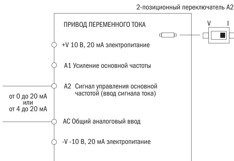
Рисунок 45. Установка сигнала управления частотой в качестве сигнала тока на контакте А2.
