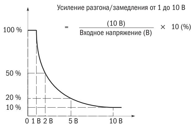
Рисунок 105. Коэффиц. усиления момента времени разгона/замедления с использованием аналогового ввода
