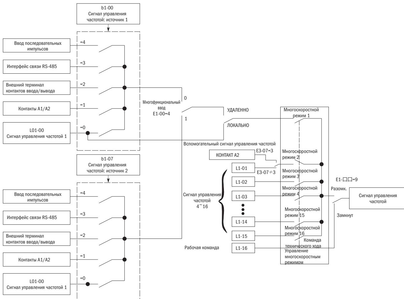
Рисунок 68. Схема сигнала управления частотой
