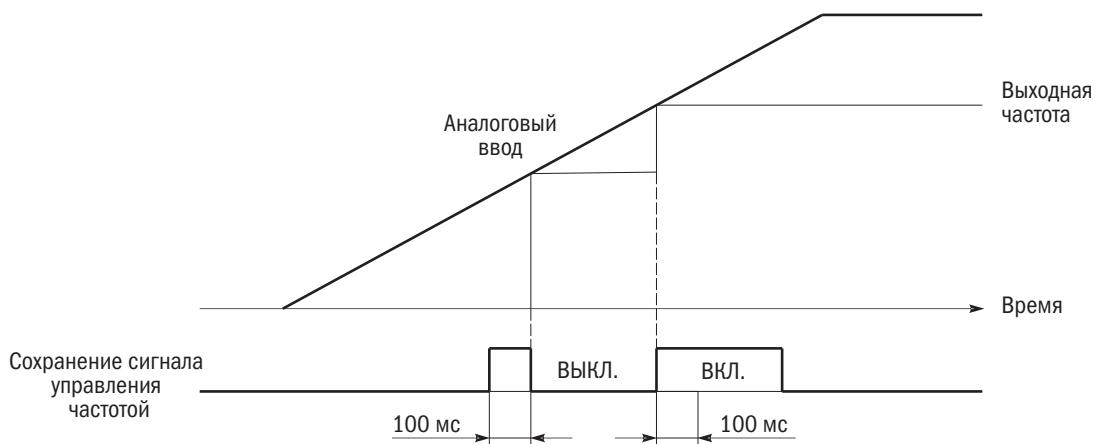
Рисунок 91. Процедура сохранения аналоговой модели сигнала управления частотой
