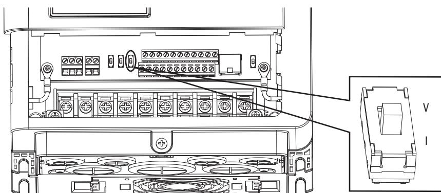
Рисунок 38. Двухпозиционный переключатель A2 > 7,5 кВт
